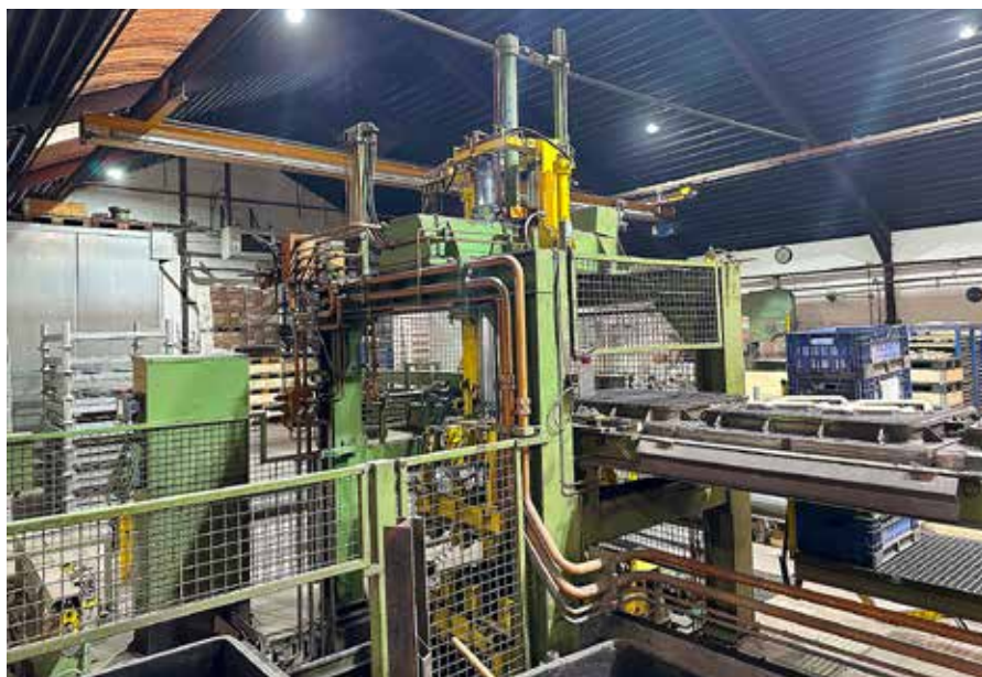
Eén van de specialisaties van AGO is zandgietwerk dat wordt vervaardigd op een automatische vormlijn.
